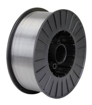
COMPOSITION % 0.25 Max Silicon Iron 0.4 Max 0.05 Max Copper 0.1 - 0.2 Manganese 4.5 - 5.6 Magnesium Zinc 0.1 Max Titanium 0.07 - 0.15 Beryllium 0.0008 Max 0.1 - 0.3 Chromium Aluminium Balance
